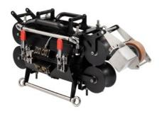
Dispositivo in grado di eseguire prove non distruttive su funi metalliche di diametro compreso tra 60 e 80 mm.
