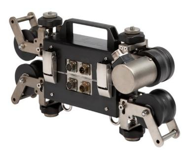
Dispositivo in grado di eseguire prove non distruttive su funi metalliche di diametro compreso tra 22 e 40 mm. Il dispositivo funziona solo su
