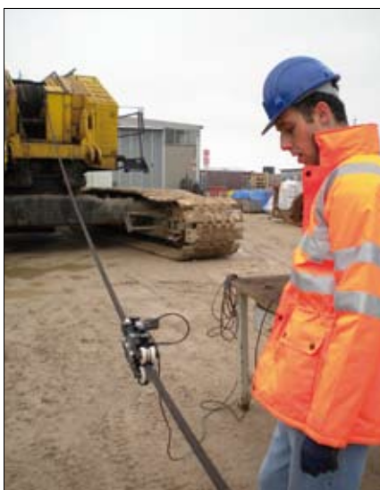
Le soluzioni proposte da AMC Instruments permettono l'individuazione di eventuali difetti distribuiti sulle funi metalliche
