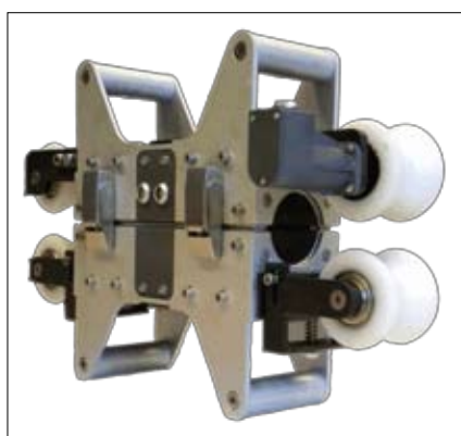
La versione AMC Rope 50: è adatta al controllo non distruttivo delle funi di impianti per il sollevamento industriale
