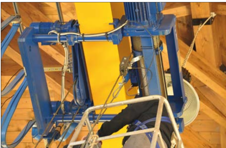
L'AMC RF16 è un prodotto progettato per operare in configurazione fissa nel controllo non distruttivo di funi di piccolo diametro impiegate nel settore del sollevamento carichi
