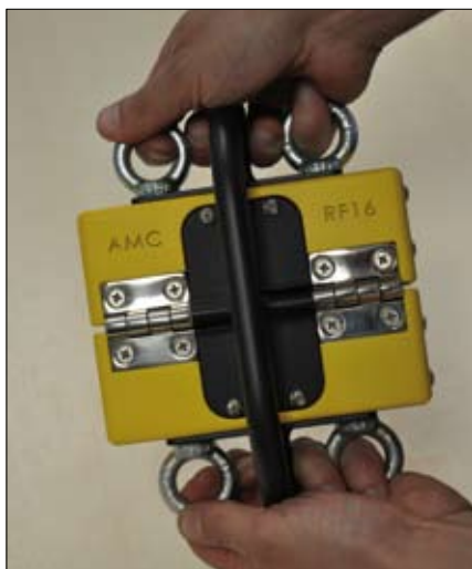
Il sistema AMC Rope 16 è una recente novità sviluppata da AMC Instruments ad è sviluppato specificatamente per il settore delle verifiche funi utilizzate negli apparecchi di sollevamento
